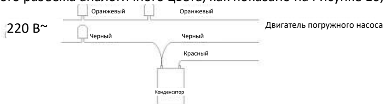
Рисунок 10: Схема подключения конденсатора
