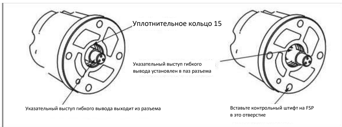
Рисунок 5: Проверка правильности установки разъема гибкого вывода
