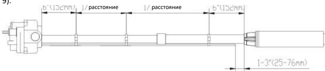
Рисунок 9: Крепление трубопровода обратной линии к насосу
